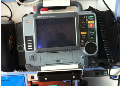
Detalle del monitor lifepak 15 con botón de SINC para la Cardioversión
